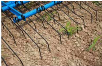
Ø7 mm compact(L=430 mm) stijvere tand, minder zijdelingse beweging
