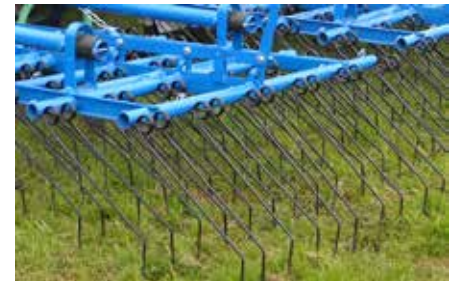
Ø 8mm compact (L=530mm) Efficiënte mosverwijdering
